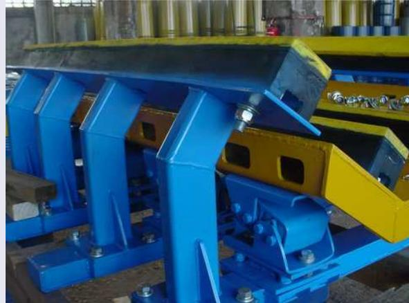
Esta **base de impacto para descarga de material** es fácil de instalar y de una construcción totalmente modular. Fabricamos los modelos de **Camas Estáticas como también Camas Dinámicas.**
