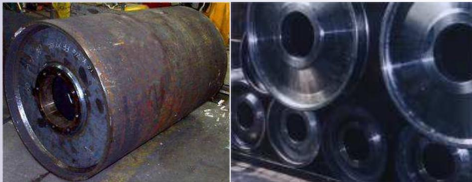
Poleas totalmente listas para su ensamblado final y mecanizado de diámetro exterior. Las poleas en este momento se encuentran totalmente soldadas.
